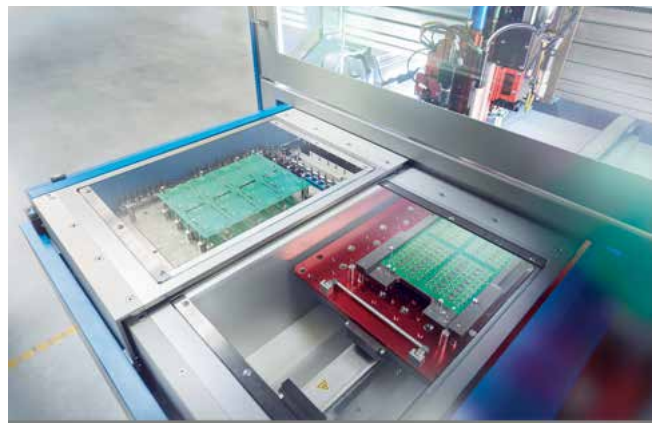
Durch die Ausrüstung mit zwei Shuttle-Systemen wird durch Vermeidung von Totzeiten eine höchstmögliche Ausbringung erreicht. When equipped with a dual shuttle system, the machine offers maximum output by avoiding time lags.
