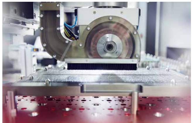
Die Maschine kann optional mit einem zusätzlichem Sägespindelmodul ausgerüstet werden. Dieses Modul ist jederzeit nachrüstbar. Die Säge kann in 0,1°-Schritten bis zu 360° gedreht werden. In der höchsten Ausbaustufe (Frässpindelmodul + Sägespindelmodul) ist es möglich, bei der Bearbeitung eines Nutzens jederzeit ohne Stillstandszeiten zwischen den beiden Fräsköpfen zu wechseln. The machine can be optionally fitted with an additional sawing disc module. The second module can be retrofitted at any time. The sawing disc can be rotated in steps of 0.1° until 360°. With the full equipment (milling bit module + sawing disc module) it is possible to switch instantly during one cycle, without retooling time, between both heads.
